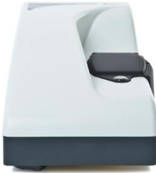
شکل ۱- دستگاه زتاسایزر برای آنالیز اندازه ذرات نانو
